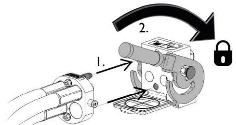
Der Hebel sollte sich leicht in die Verriegelungsposition bewegen lassen. Gleitet der Hebel nicht oder nur mit Druck in seine Position, überprüfen Sie Ausrichtung und Position der Anschlüsse und Verbinder und reinigen Sie sie ggf. Schalten Sie den Lader aus und lassen Sie den restlichen Hydraulikdruck ab.
